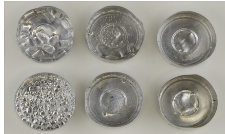
Abb.2: Voruntersuchungen zum Einschmelzen von Paraloid B72 . (Foto A. Hering)
