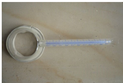
Abb.3: Prüfzylinder nach Karsten
