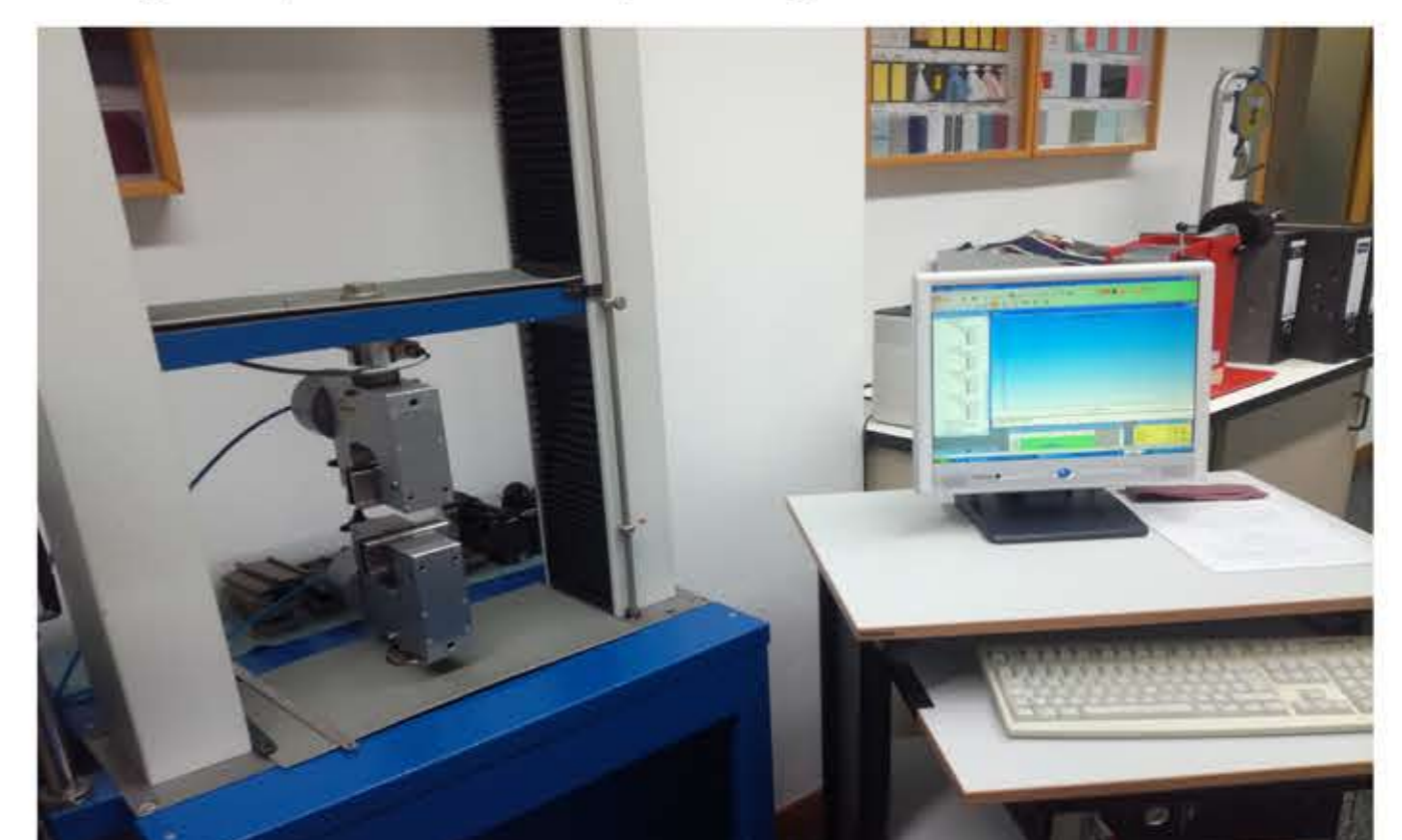
Abb.3: Materialprüfmaschine zur Bestimmung der Zugscherfestigkeit im FB 5 der HTW
