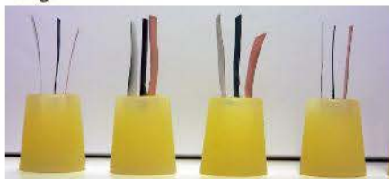
Abb.1 - Oddy Test nach GREEN und THICKETT [1995]
