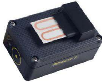
Abb.2 - MUSECORR-Logger AirCorr I (links) 4 und Auswertung der Messergebnisse (rechts) 5
